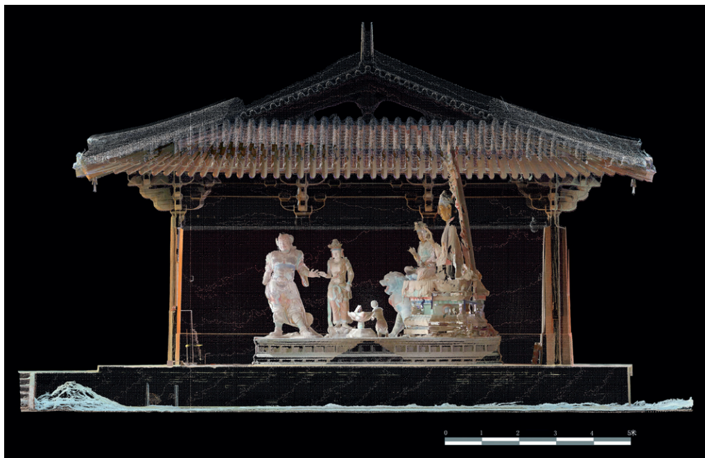
图28 南禅寺大殿建筑像设横剖面点云图 (笔者团队采集)
