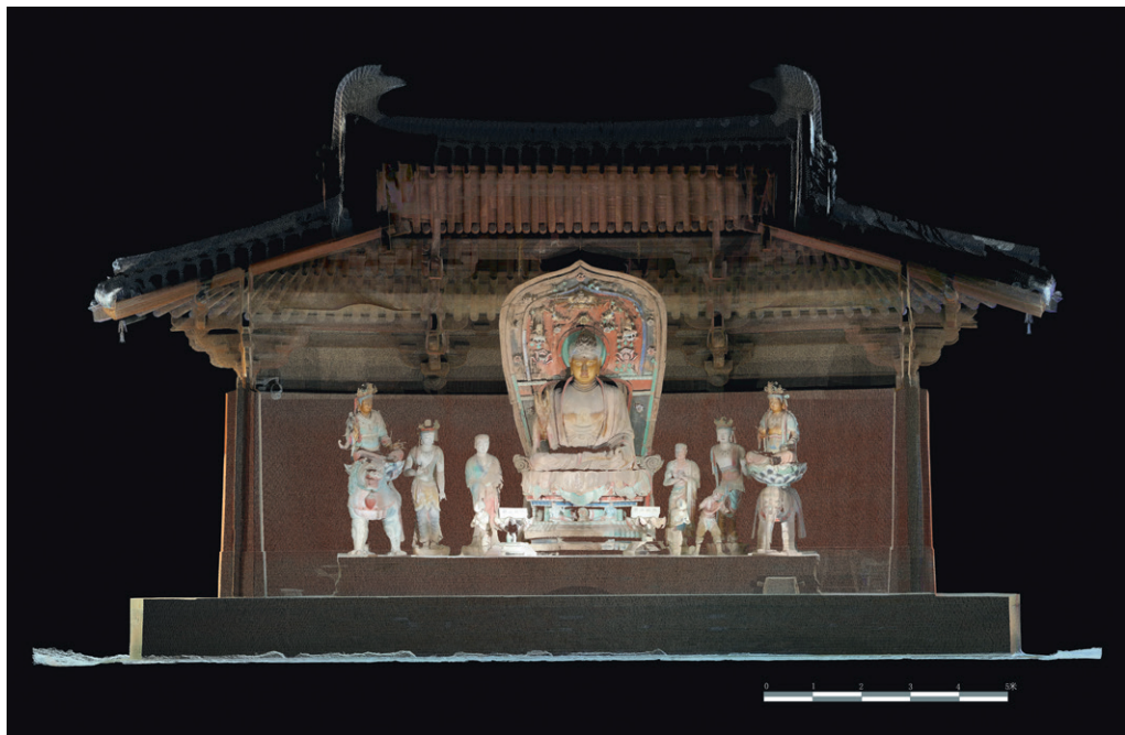
图27 南禅寺大殿建筑像设纵剖面点云图 (笔者团队采集)
