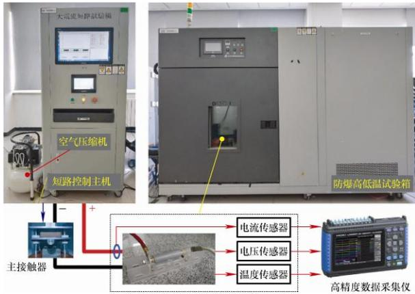
图 2 动力电池单体外部短路试验平台
